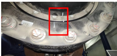
图3 力矩限制器打滑
